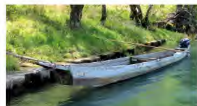
りょうぶね 漁舟 (中流の川漁に使用) 9~11m。両端が三角。木造舟は石にあたった音が響かず、魚が逃げにくいといえます。
